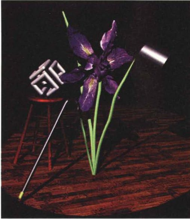
Questa immagine rappresenta un esempio di shadow casting in real-time con in più l'effetto occhio di bue descritto nell'articolo. Muovere la fonte luminosa e ricalcolare le ombre in tempo reale esalta notevolmente la tridimensionalità della scena (riconoscerete per caso il logo?). Courtesy of Performer Team, Silicon Graphics Corporation.
